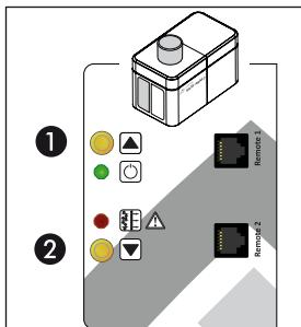
Todos los ajustes del dispositivo se realizan a través de dos pulsadores ubicados en la pantalla. La pantalla ① se halla en el lado izquierdo y la ② en el derecho. Excepto en el modo maestro/esclavo, ambos lados se pueden regular independientemente entre sí. Con el pulsador superior se hace referencia al botón ① y el inferior, al botón ②. Los botones están activos mientras estén encendidos e inactivos, cuando estén apagados.
