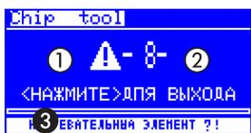
Прибор i-CON 2 выполняет самостоятельно диагностику неисправностей. Результат диагностики выдаётся в кодах, соответствующих каждой неисправности: В этом случае на дисплее паяльной станции появляется пиктограмма в виде треугольника ①. Код неисправности ② обозначается номером от 2 до 99.
