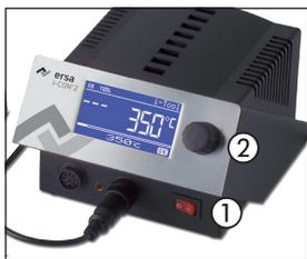
Включение/выключение паяльной станции происходит с помощью выключателя на его передней панели ①. Паяльная станция находится в рабочем состоянии, если выключатель подсвечивается красным светом.
