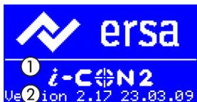
После включения станции на короткое время - около 2 секунд - появится диалоговое окно подключения. В нём показываются идентификационные данные станции ① и версия программного обеспечения ② станции i-CON 2. Сразу после этого станция автоматически переходит в рабочий режим.
